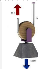
Polea móvil con una sólo polea
