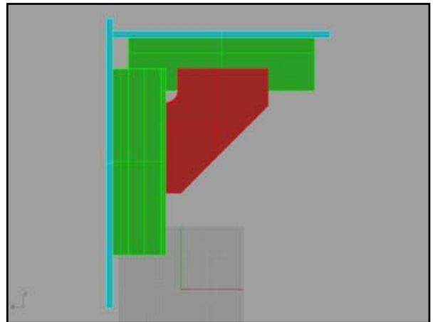
Cartela Plana que se encuentra en el mismo plano del alma del perfil L del costado del casco.
